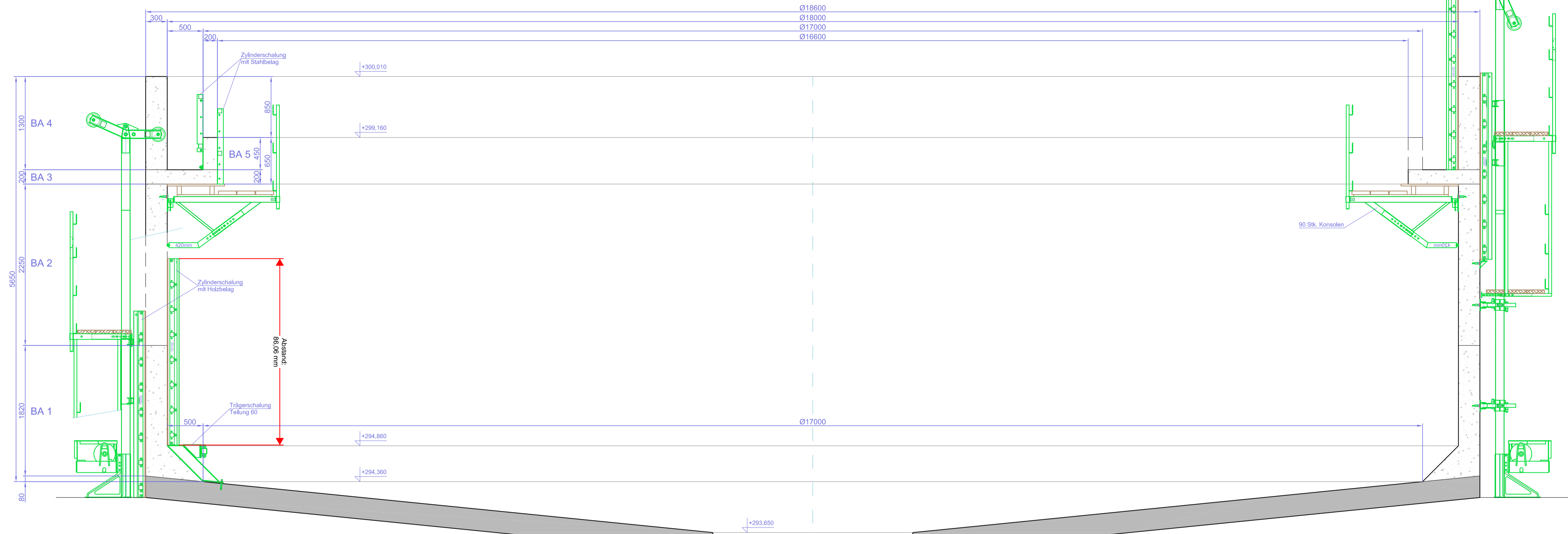
Heben der Außenschalung ø18,6m
